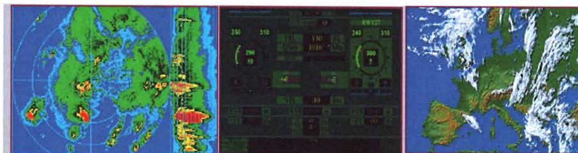
Радарно изображение от метеорологичен доплеров радар собственост на ДП РВД, Система SALI изобразяваща стойностите на метеорологични елементи измерени на пистата за излитане и кацане и Сателитно изображение от геостационарен метеорологичен спътник.
